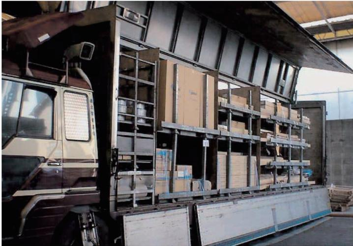
「モジュールパレット」を活用して他品種の部材を運ぶトラック。効率的な積載が可能でキズ・破損も減らせる
